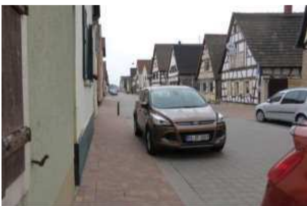
Abbildung 5-8: In den neu gestalteten Bereichen kommt es häufig zu folgender Problemsituation: Pkw weichen in den umgebauten Bereichen an Engstellen (Gegenverkehr, parkende Fahrzeuge) auf den niveaugleichen Bürgersteig aus. Durch die Installation von Pollern soll die Gefährdung der Fußgänger entgegengewirkt werden.
