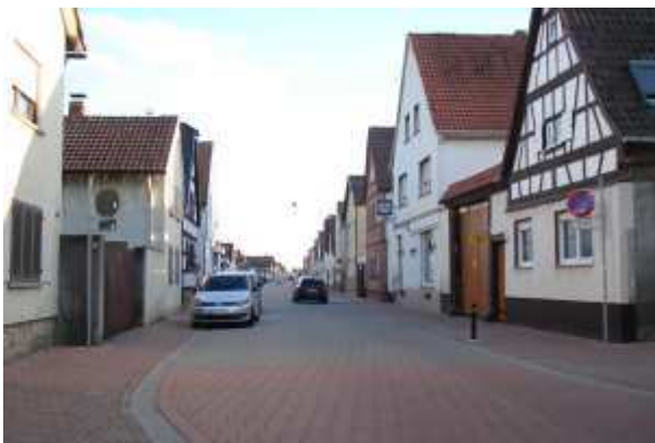
Abbildung 5-7: Steigerung der Attraktivität für Fuß- und Radverkehr durch die niveaugleiche Straßengestaltung in der Hauptstraße in Böhl. Parken ist im Gegensatz zu früher auf der Fahrbahn nicht mehr erlaubt. Fahrbahneinfärbungen sorgen für erhöhte Aufmerksamkeit der Verkehrsteilnehmenden an Knotenpunkten
