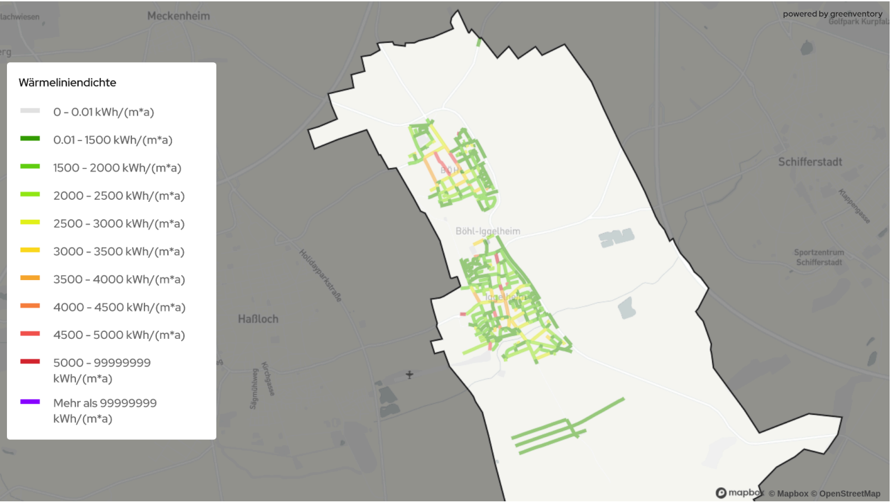
Abbildung 11: Aktuelle Wärmelinienidichten der einzelnen Straßenabschnitte
